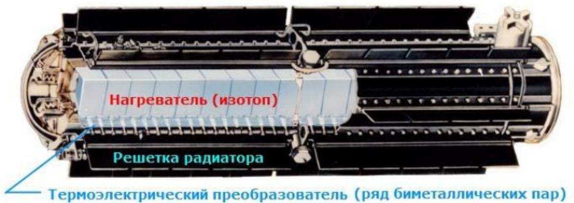
*Рисунок 26. Термоэлектрический преобразователь*
