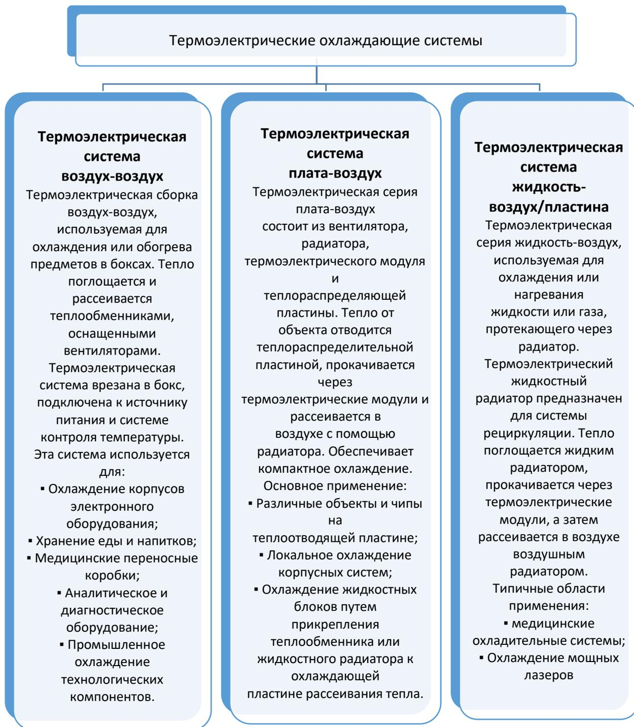
Рисунок 17. Термоэлектрические охлаждающие системы
