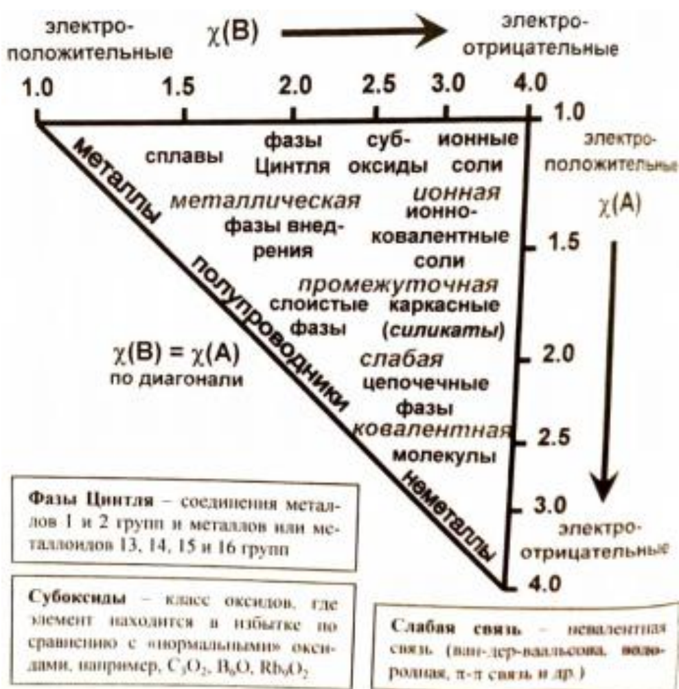
Рисунок 49. Электроотрицательность определяет характер химической связи, а также возможные составы и структуры
