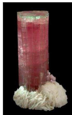
Структура и внешний вид кристаллов турмалина \text{Na}(\text{Li}_{1.5}, \text{Al}_{1.5})\text{Al}_6\text{Si}_6\text{O}_{18}(\text{BO}_3)_3(\text{OH})_4 – первого известного пироэлектрика
